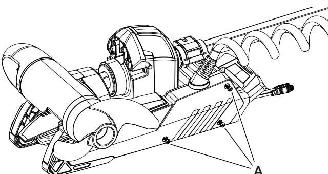
3. 卸下侧板, 请谨慎操作, 避免定位片在离开定位槽 (B) 时遭受损坏。
