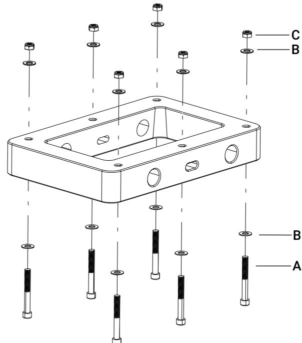
→ 注意:电推马达安装托架必须位于顶板中心,不得悬伸,以确保可以正确地重装侧板。
