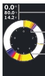
闪光灯应用程序可显示原始实时声纳视图，通常用于冰下捕鱼和垂钓等场景。
