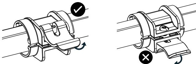
7. 从套环的底面安装螺栓并以1.7 Nm (1.3 lb-ft) 的扭矩拧紧。
