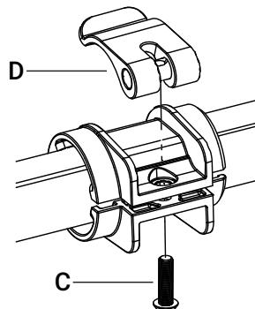
6. 按照与旧凸轮锁深度套环和锁定杆相同的位置和方向放置新凸轮锁深度套环和锁定杆。注意不要弄丢可在锁定杆内自由移动的金属管。
