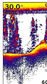
A aplicação Sonda apresenta uma imagem da água e do leito do mar sob a embarcação, permitindo-lhe detetar peixes e examinar a estrutura do leito do mar. Utilize as teclas de zoom para ver diferentes partes da coluna de água.
