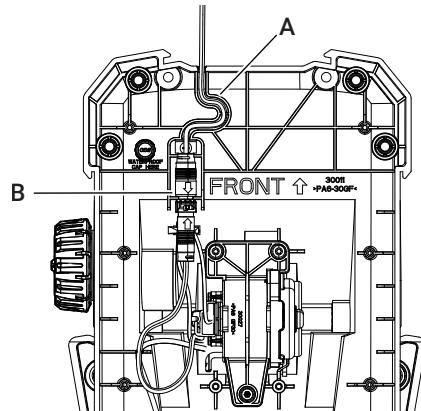
Para instalar o novo cabo de alimentação de 12 V:
