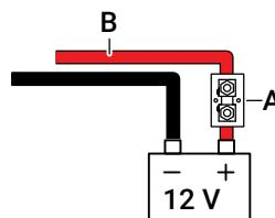
**⚠ AVISO:** Não é possível utilizar o mesmo sistema de baterias de 24 V ou 36 V utilizado para alimentar o motor de pesca. É necessária uma fonte de alimentação de 12 V dedicada. A bateria de arranque/do sistema eletrônico pode ser utilizada, caso se trate de uma bateria de 12 V.
