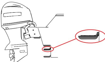
É possível montar o transdutor num suporte para painel de popa. Esta opção de montagem permite manter o transdutor na água quando a embarcação está a planar, ou colocá-lo apenas na água quando a embarcação se movimenta a velocidade de pesca ao corriço.
