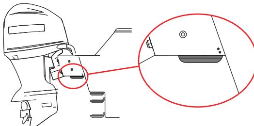
É possível montar o suporte para painel de popa do transdutor dentro e fora da placa de elevação ao perfurar a mesma e, em seguida, passar os parafusos através do orifício da dobradiça na lateral do suporte para os apertar na placa de elevação. A ilustração acima apresenta o suporte para painel de popa montado no interior da placa de elevação.
