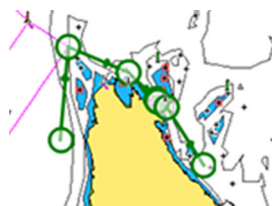
Resultaat na automatische routebepaling
