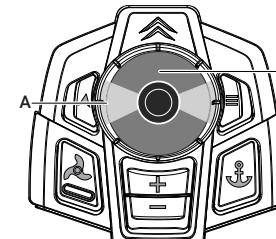
Nelle modalità Autopilota, spostare il joystick a sinistra o a destra per ruotare l'unità inferiore in incrementi, oppure spostare e tenere premuto il joystick in qualsiasi direzione per ruotare l'unità inferiore in quella direzione. Quando si rilascia il joystick, la direzione dell'unità inferiore diventa la nuova rotta o direzione.
