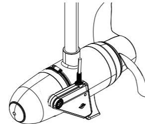
**AVVERTENZA:** quando si installa il trasduttore, lasciare un margine sufficiente nell'anello del cavo in modo che il palo del motore possa ruotare completamente senza danneggiarlo.
