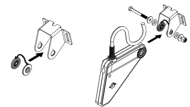
Serrare fino a quando le rondelle in gomma non si espandono fino al diametro delle rondelle metalliche. Non serrare eccessivamente.
