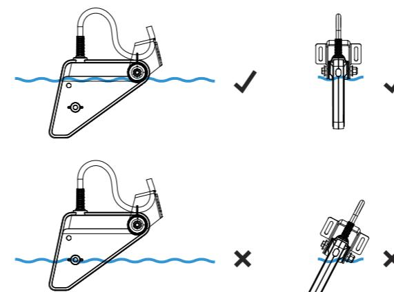
Montare il trasduttore parallelamente alla superficie dell'acqua.
