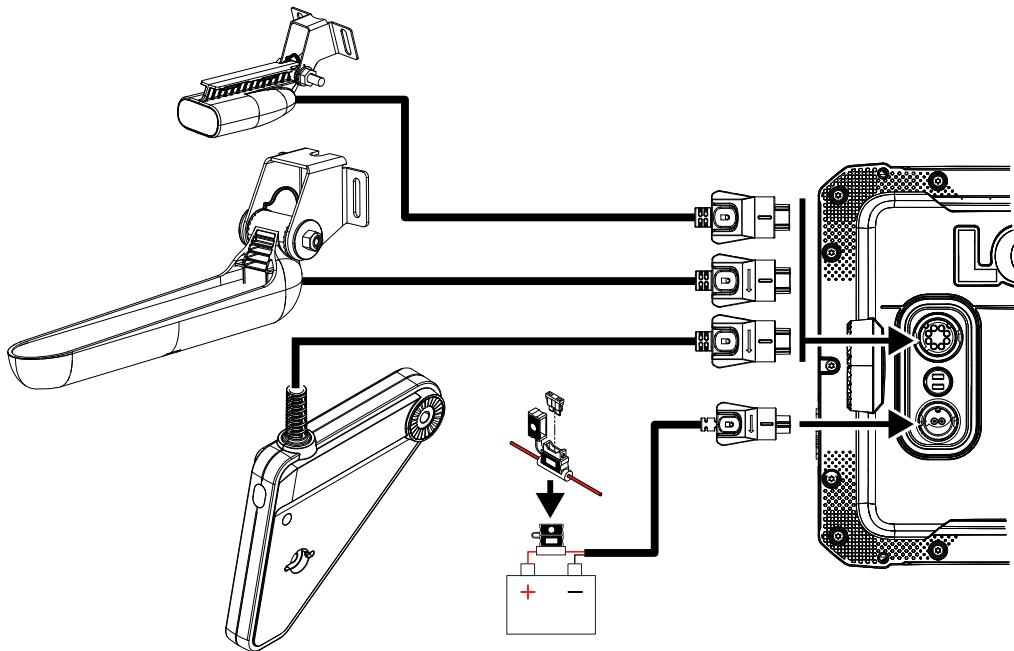
Collegare un trasduttore SplitShot™, TripleShot o Eagle Eye™. Fare riferimento alle informazioni incluse per l'installazione del trasduttore.
