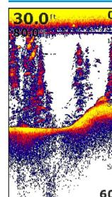
L'applicazione Sonar mostra un'immagine dell'acqua e del fondale marino sotto l'imbarcazione, consentendo di rilevare la presenza di pesci e di esaminare la struttura del fondale.
