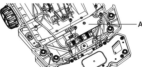
→ **Nota:** adesso il modulo tasti inferiore non è supportato ed è fissato solo per mezzo del connettore.
