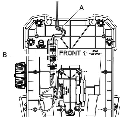
Per installare il nuovo cavo di alimentazione da 12 V:
