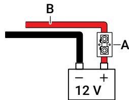
**AVVERTENZA:** non è possibile utilizzare lo stesso sistema di batterie da 24 V o 36 V utilizzato per alimentare il motore per pesca alla traina. È necessaria una fonte di alimentazione dedicata a 12 V. La batteria di avviamento/elettronica può essere utilizzata se si tratta di una batteria da 12 V.
