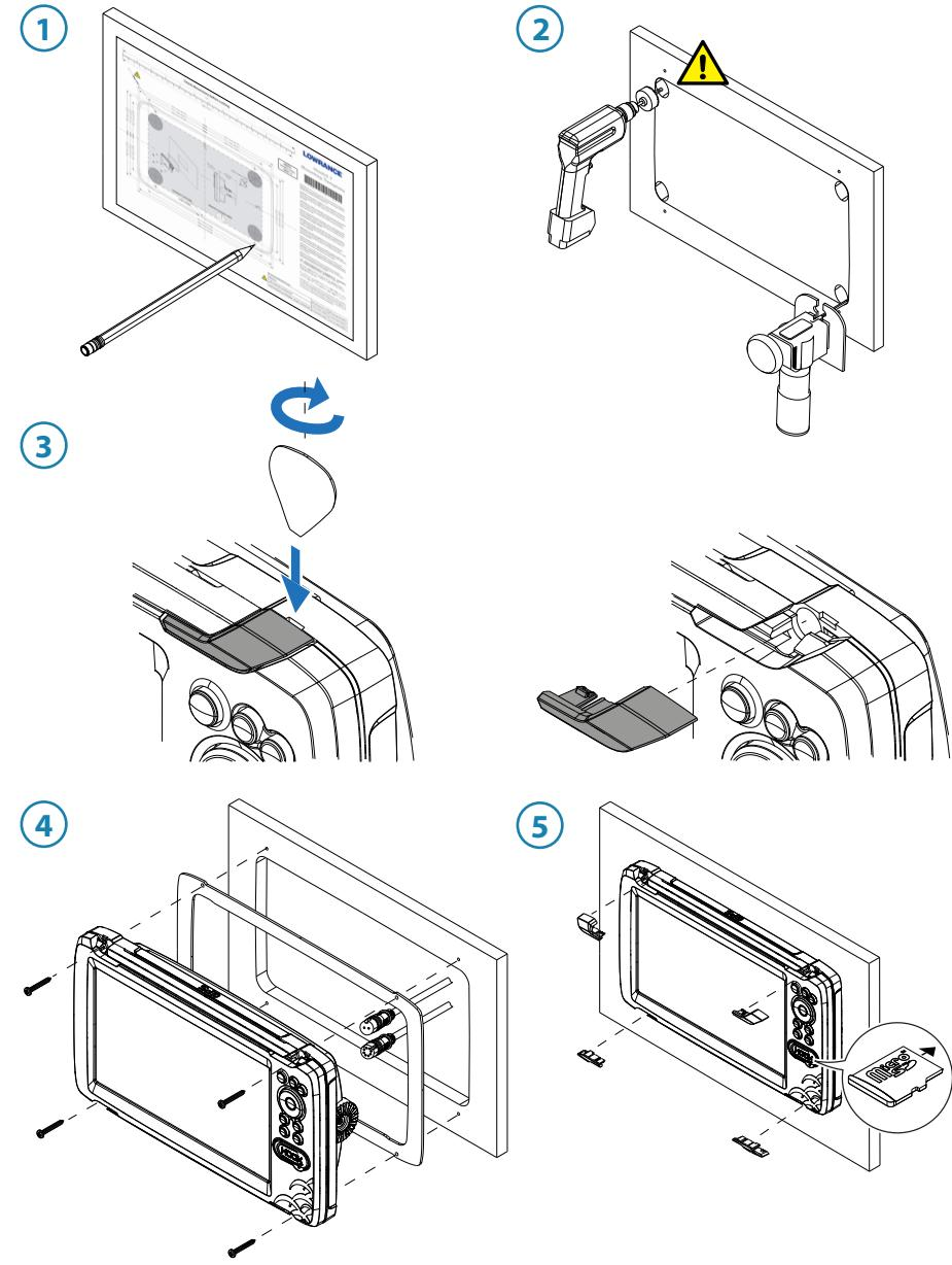
⚠ Voir le modèle de montage sur tableau de bord pour les détails de perçage et de découpe.
