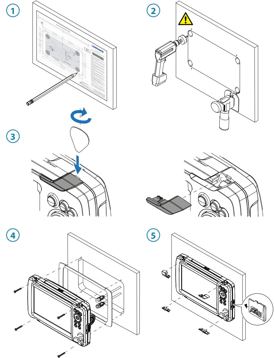
⚠ Voir le modèle de montage sur tableau de bord pour les détails de perçage et de découpe.
