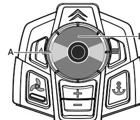
En mode Pilote auto, déplacez le joystick vers la gauche ou vers la droite pour faire tourner l'unité inférieure par incrément, ou déplacez-le et maintenez-le dans n'importe quelle direction pour tourner l'unité inférieure dans cette direction. Lorsque vous relâchez le joystick, la direction de l'unité inférieure devient votre nouvelle route ou votre nouveau cap.
