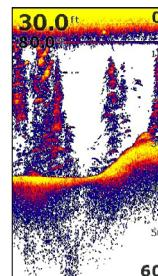
L'application de sondeur affiche une image de l'eau et du fond marin sous votre bateau pour vous permettre de détecter les poissons et d'examiner la structure du fond marin.
