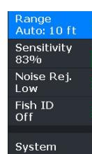
Par défaut, votre appareil est en mode **Auto** et les paramètres de l'application de sondeur sont automatisés. Appuyez sur la touche Menu pour accéder aux paramètres du sondeur à personnaliser.
