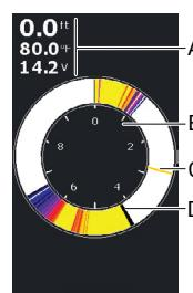
L'application Flasher affiche une vue de sondeur brute en temps réel couramment utilisée dans des scénarios tels que la pêche sur glace et la pêche verticale au jig.
