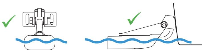
→ **Nota:** Monte el transductor en paralelo a la superficie del agua.
