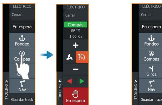
El piloto automático se activará en el modo seleccionado y el controlador del piloto automático volverá a mostrar las opciones del modo activo.
