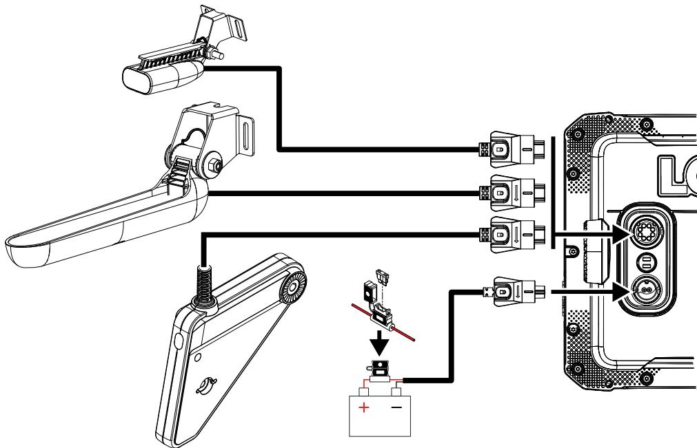
Conecte un transductor SplitShot™, TripleShot o Eagle Eye™. Consulte la información de instalación del transductor incluida.
