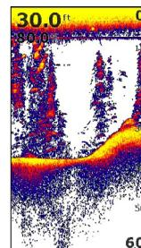
La aplicación de la sonda muestra una imagen del agua y del fondo que se encuentra debajo de su embarcación, lo que le permite detectar peces y examinar la estructura del lecho marino.
