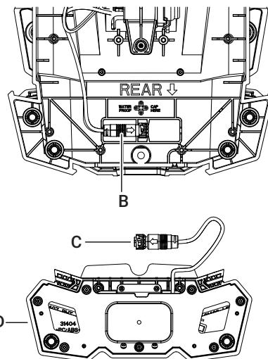
Montaje del nuevo módulo de teclas inferior:
