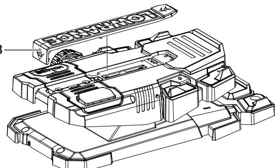
3. Presione la lengüeta de bloqueo de la cubierta del FlipSwitch™ (**C**) y levante dicha cubierta para retirarla.
