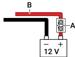
**⚠ ADVERTENCIA:** No puede utilizar el mismo sistema de batería de 24 o 36 V utilizado para alimentar el motor eléctrico. Necesita una alimentación dedicada de 12 V. La batería de arranque/electrónica se puede utilizar si es de 12 V.
