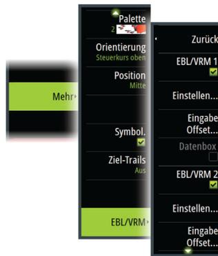
Der EBL/VRM-Marker wird jetzt auf dem Radarbild positioniert.
