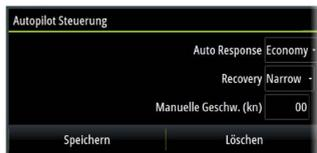
Diese Option ermöglicht die manuelle Änderung von Parametern, die während der Inbetriebnahme des Autopilot-Computers eingestellt wurden. Weitere Informationen zu den Einstellungen finden Sie in der separaten Dokumentation für den Autopilot-Computer.
