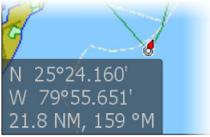
Wenn der Cursor aktiv ist, wird das Fenster mit der Cursor-Position angezeigt. Bei aktivem Cursor verschiebt oder dreht sich das Bedienfeld nicht, um dem Schiff zu folgen.
