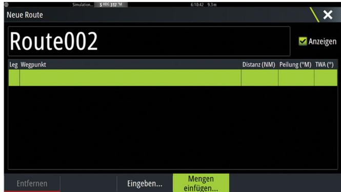
6. Geben Sie eine Liste von Wegpunkten durch Kommas getrennt ein (z. B. 21,22,23,24). Sie können Rundungsanzeigen in dem Mengeneintrag einbeziehen, indem Sie .P (Backbord) oder .S (für Steuerbord) den Wegpunkten (z. B. 21.S, 22.P, 23.S, 24.P) hinzufügen. Das System ändert die Route in einer Regattaroute, wenn Rundungsanzeigen in dem Mengeneintrag enthalten sind.
