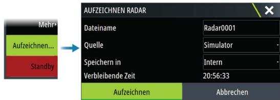
Sie können Radardaten aufzeichnen und die Datei auf dem -Gerät selbst oder auf einem Speichergerät speichern, das mit dem Gerät verbunden ist..
