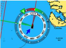
Sie können das SailSteer-Bild als Overlay in die Karte einblenden. Das SailSteer-Bild-Overlay kann über das Dialogfenster "Karteneinstellung" (Chart setting) aktiviert und deaktiviert werden.
