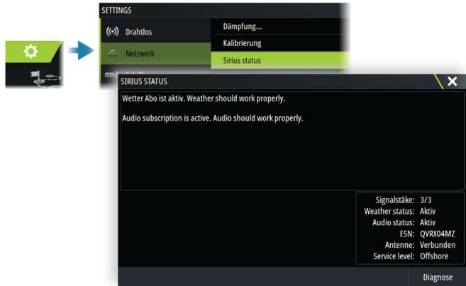
Im Statusfeld wird die Signalstärke als 1/3 (schwach), 2/3 (gut) oder 3/3 (bevorzugt) angezeigt. Es werden auch der Antennenstatus, das Service-Level und die elektronische Seriennummer für das Wettermodul angezeigt.
