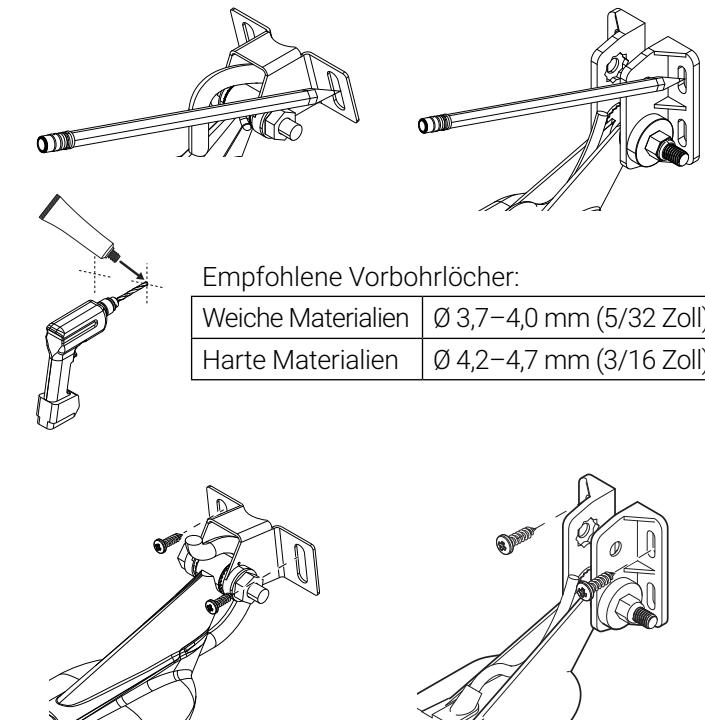
→ **Hinweis:** Füllen Sie die Vorbohrungen mit einem hochwertigen seewässerfesten Dichtmittel.
