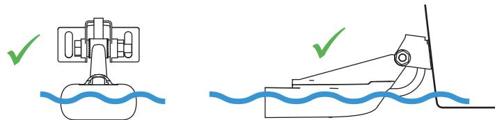
→ **Hinweis:** Montieren Sie den Schwinger parallel zur Wasseroberfläche.
