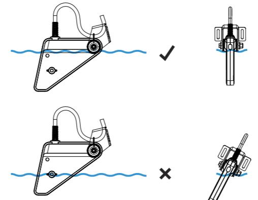
Montieren Sie den Swinger parallel zur Wasseroberfläche.
