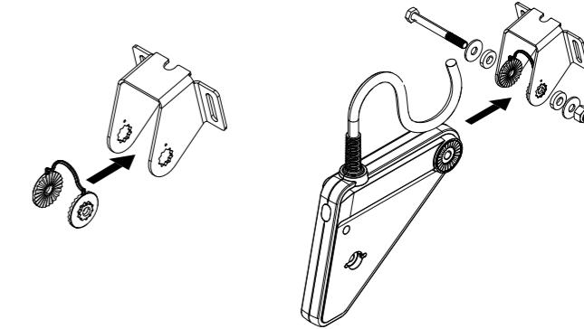
Ziehen Sie fest, bis sich die Gummischeiben auf den Durchmesser der Metallscheiben ausdehnen. Ziehen Sie nicht zu fest an.
