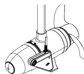
**WARNING:** Bei der Montage des Schwingers muss das Kabel locker genug sein, damit sich die Motorwelle vollständig drehen kann, ohne das Kabel zu beschädigen.
