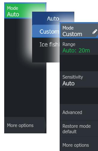
Standardmäßig ist auf dem Gerät der **Auto**-Modus eingestellt, und alle Einstellungen sind automatisiert. Wählen Sie **Auto** im Bedienfeldmenü, und wechseln Sie in den Modus **Eigene Einstellung** (Custom), um die Sonareinstellungen anzupassen.
