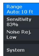
Standardmäßig ist auf dem Gerät der **Auto**-Modus eingestellt und die Einstellungen der Flasher-Anwendung sind automatisiert. Drücken Sie die Menütaste, um die Flasher-Einstellungen aufzurufen, die Sie anpassen möchten.
