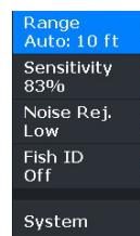
Standardmäßig ist auf dem Gerät der **Auto**-Modus eingestellt, und die Einstellungen der Sonar-Anwendung sind automatisiert. Drücken Sie die Menütaste, um die Sonareinstellungen aufzurufen, die Sie anpassen möchten.
