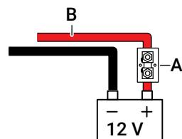
**⚠️ WARNUNG:** Sie können nicht dasselbe 24-V- oder 36-V-Batteriesystem verwenden, das für die Stromversorgung des Trollingmotors verwendet wird. Sie benötigen eine gesonderte 12-V-Stromquelle. Die Starter-/Elektronikbatterie kann genutzt werden, wenn es sich um eine 12-V-Batterie handelt.
