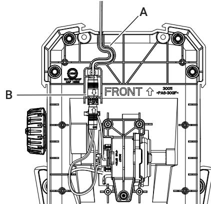
So installieren Sie das neue 12-V-Netzkabel:
