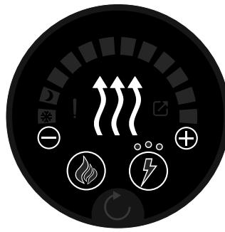
Abbildung 2. Bedienfeld der Whale-Heizungssteuerung
