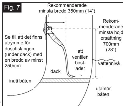
**Notera:** Före installationen - kontrollera att det finns tillräckligt med plats för slangen när den förvaras. Kontrollera också att den inte hindras av något när den dras ut.
