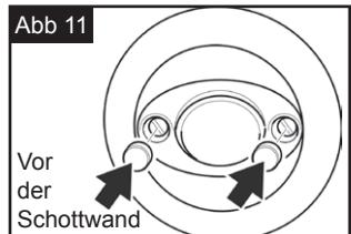
**SCHRITT 6** Drücken Sie die Kunststoffkappen mit der Hand in die Schraubenlöcher. (Siehe Abb. 11).
