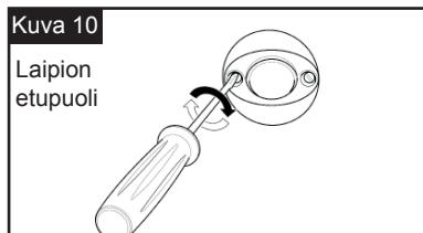
**VAIHE 5** Työnnä kotelo läpi asennusreijästä (kuva 9). Asenna kiristämällä kaksi ruuvia etupuolelta kunnes laippa on tukevasti kiinnitetty laipioon (katso kuva 10). Sen tulee koskettaa laipiota joka kohdaltaan. Varmista, että ruuvireiät ovat vaakasuorassa suunnassa.
