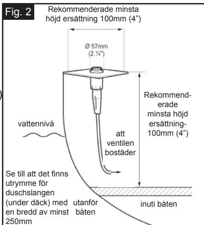
**STEG 2** Borra ett runt hål med diameter 50mm (2") i skiljeväggen ovanför vattenlinjen. Se till att det finns tillräckligt med plats på höjden och djupet som visas på Fig. 2. (Se Fig. 3) Notera:-minimum tjocklek monteringsyta: 3mm (1/8"); maximum tjocklek monteringsyta 19mm (3/4").
