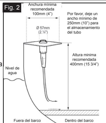
**PASO 2** Teniendo en cuenta las restricciones de altura y anchura indicadas en la Fig. 2, taladre un orificio circular de 50 mm (2") de diámetro en la superficie
