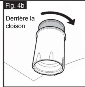
**ETAPE 3** Insérer le support dans le trou. Serrer le contreécrou à la main sur le support derrière la cloison. Voir Fig. 4a et 4b.
