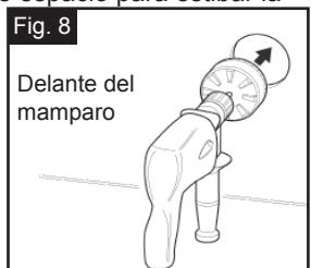
**PASO 3** Para facilitar la instalación del soporte y de los anillos de soporte, los dos tornillos deben aflojarse hasta casi desacoplarse de la parte roscada.
