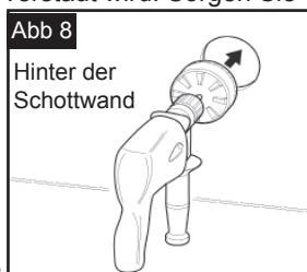
**SCHRITT 3** Um die Montage des Halters und der Stützringe zu erleichtern, lösen Sie die beiden Schrauben bis zum Ende des Gewindeganges.
