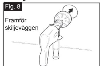
**STEG 3** För att möjliggöra enklare montering av hållare och supportringar skall de 2 skruvarna lossnas tills de nästan är avgängade.
