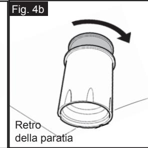
**FASE 3** Collocare il supporto nel foro. Stringere manualmente il dado di bloccaggio sul supporto dietro la paratia. Vedere Fig. 4a e 4b.
