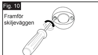
**STEG 5** Placera höljet genom hålet (Se Fig. 9). Installera genom att dra åt de 2 skruvarna i framkanten tills flänsen är monterad säkert på skiljeväggen (Se Fig. 10), d.v.s att den täcker hela omkretsen. Kontrollera att skruvhålen är på en horisontell yta.
