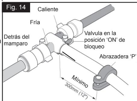
**PASO 4.** Montaje de la abrazadera "P" en el mamparo. Atornille la abrazadera "P" en el mamparo a una distancia mínima de 300 mm (12") del alojamiento de la válvula (Ver Fig. 14).
