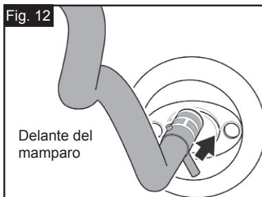
**PASO 7** Haga pasar la manguera por la carcasa hasta que la alcachofa se coloque en su lugar. (Ver Fig. 12). Consulte la sección 8 para la instalación de la tubería.
