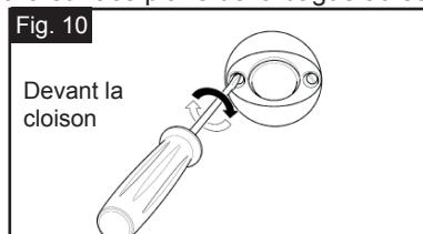
**ETAPE 5** Insérer le support dans le trou (Voir Fig. 9) Installer celui-ci en serrant les 2 vis par la face avant jusqu'à ce que la corolle du support soit correctement installée sur la cloison (Voir Fig. 10) c.-à-d. en étant en contact sur tout le pourtour. Vérifier que les trous de vis se situent sur un plan horizontal.
