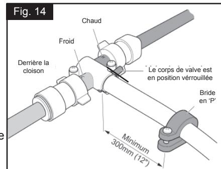
**Remarque** Pour fixer correctement l'unité, s'assurer que la surface de montage de la bride en "P" possède une épaisseur minimum de 19 mm (3/4").
