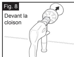
**ETAPE 3** Pour permettre une installation plus facile du support et des anneaux de support, les deux vis doivent être desserrées jusqu'à être presque entièrement désengagées de la partie taraudée.
