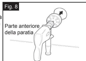
**FASE 3** Per permettere l'installazione del supporto e degli anelli, le due viti devono essere smollate fino quasi al distacco dalla filettatura.
